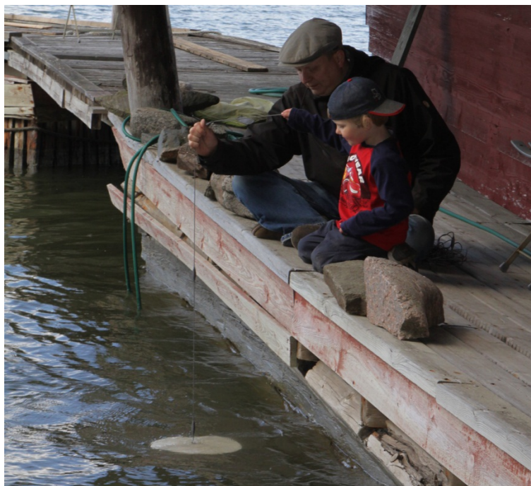
Kuva 1. Näkösyvyyshavaintojen tekoa Secchi-levyllä. Kuvaaja: Katariina Kiviluoto
