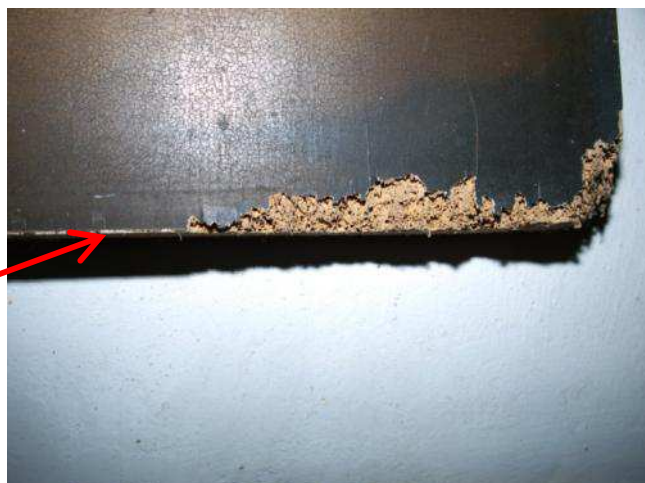
Foto 154. Intensiivne mardikakahjustus ikooni alumisel serval
