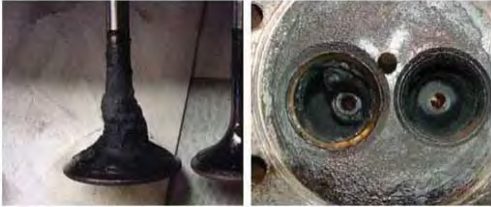
Kuva 4.10: Rypsiöljypolttoaineen aiheuttamia karstamuodostumia pakoventtiilin varressa sekä pakokanavassa. Osat ovat Valmet 420 -moottorista, polttoaineena on käytetty sinappi- ja rypsiöljyä.
