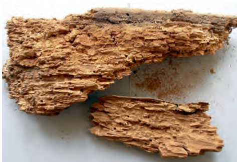
Foto 43. Puit, mida kärsaklased on tugevasti kahjustanud.
