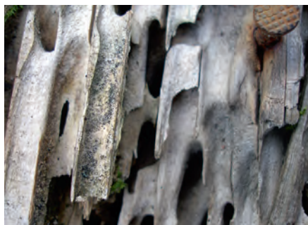
Foto 45. Hobusipelgate poolt näritud käigud puidus.
