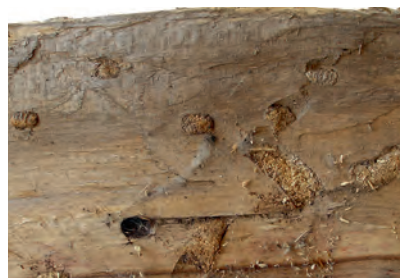
Foto 40. Siklaste kahjustused puidus. Suured ovaalsed käigud on täidetud näripuruga.
