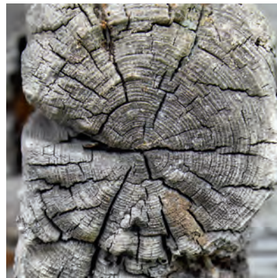
Foto 6. Keskkonnatingimuste mõjul toimub puidupinna aeglane erosioon.
