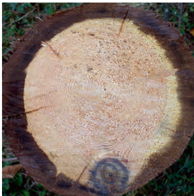
Foto 33. Kresooliga immutatud elektripost.
